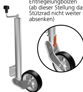
Klemmhalter zum Höhenverstellen und Befestigen des Stützrads
